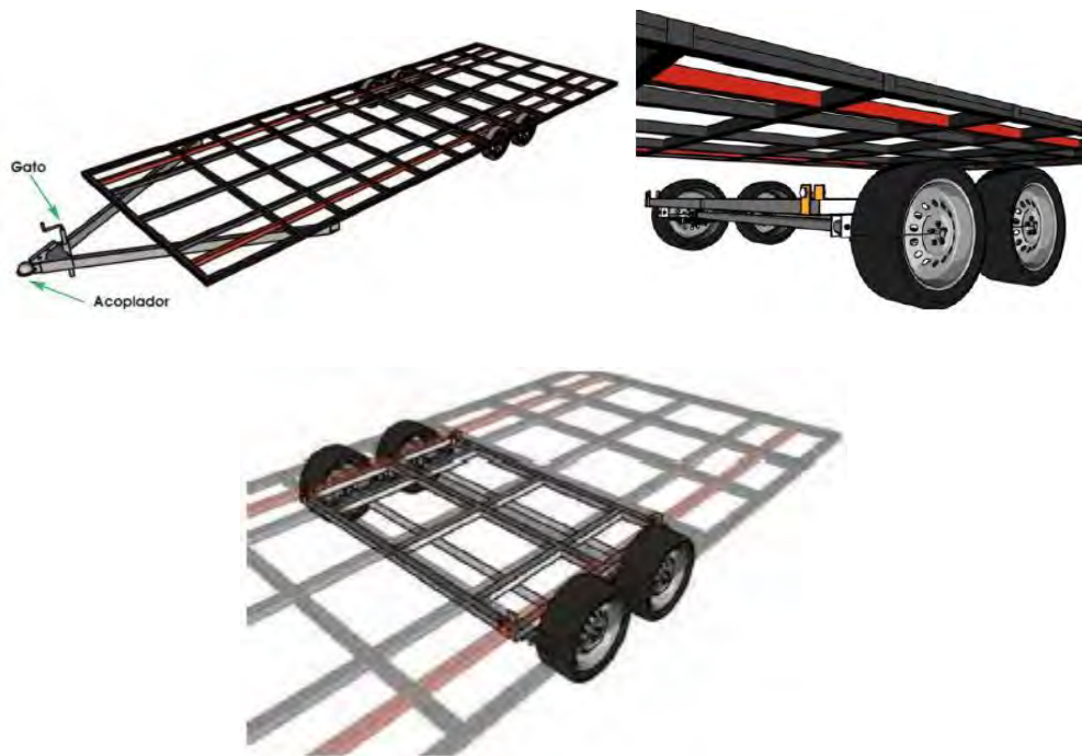
Figura 2. Sistema de rodamiento y arrastre.
