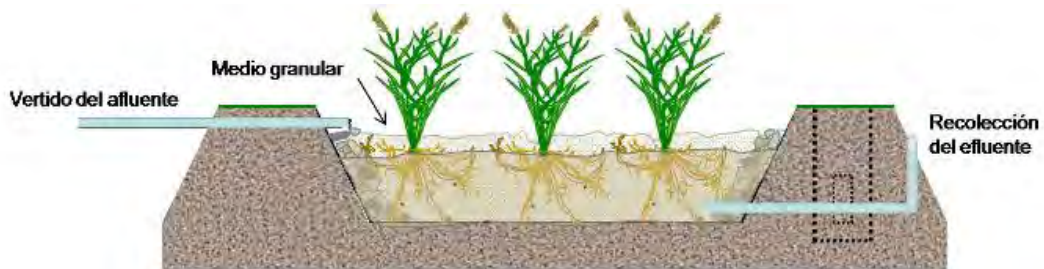
Humedal artificial horizontal de flujo subsuperficial
