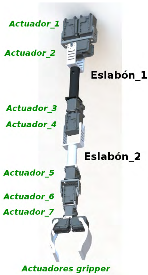
Figura 4.8: Diseño asistido por computadora del brazo robótico del robot Justina. Se realizó en modelado de partes utilizando el software SolidWorks(c). Muestra del ensamble final.
