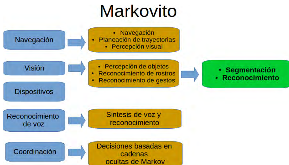
Figura 2.2: Estructura de software del robot Markovito.
