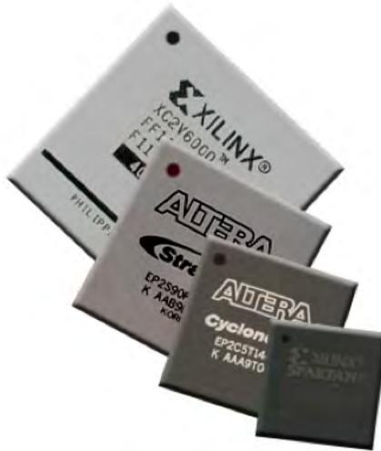
Figura 2.6: FPGA manufacturados por Xilinx y Altera
