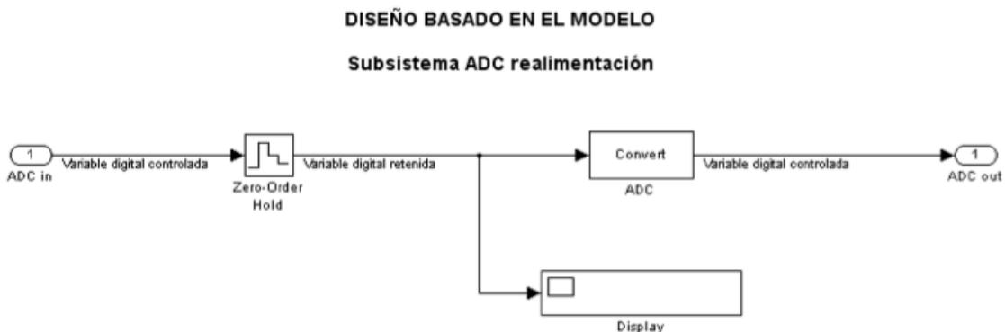
Figura 4.8: Bloque del subsistema conversión ADC de realimentación
