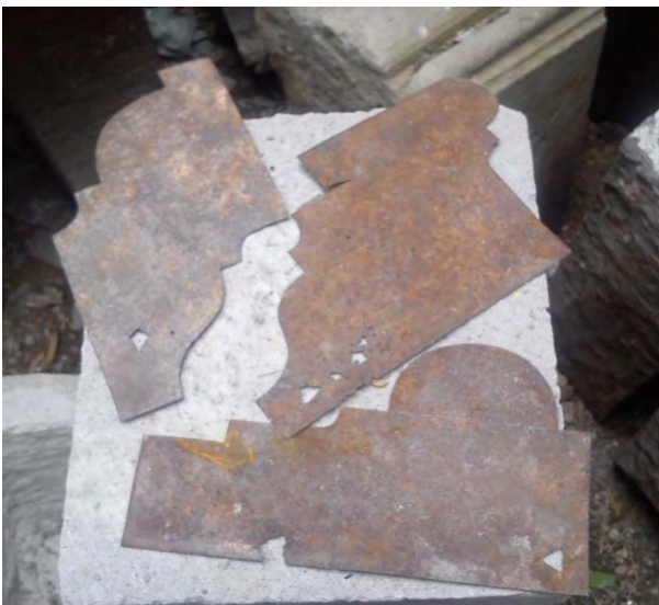
Figura 22. Plantillas de latón de cornisas de diferentes tamaños. Taller de labrado de cantera "ARAIN", San Miguel de Allende, Gto. Foto de Ruth Olvera, 2016.
