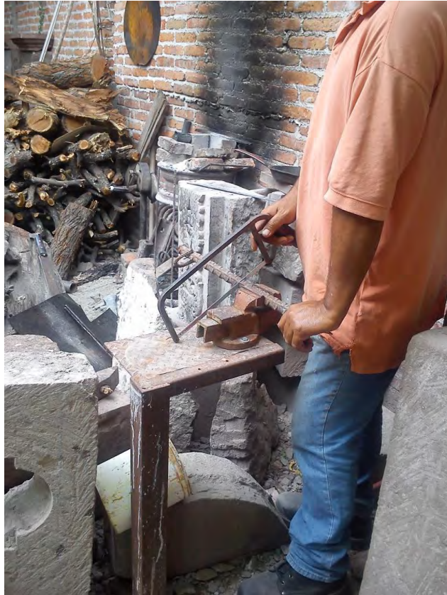
Fig. 19. Se muestra el proceso de elaboración de herramienta del cantero. Utilizando una segueta y una varilla corrugada de 1" aproximadamente para moldear el tamaño del cincel. Taller de Labrado de cantera "ARAIN", San Miguel de Allende, Gto. Foto de Ruth Olvera, 2016
