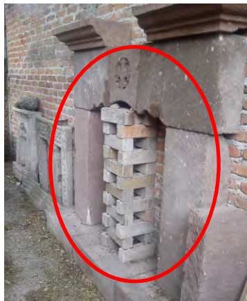
Fig. 31 En el círculo se muestra una torre de bloques de cantera sobrepuestos a tamaño escala, ubicados en el taller de labrado de cantera ARAIN. Foto de Ruth Olvera, 2016.
