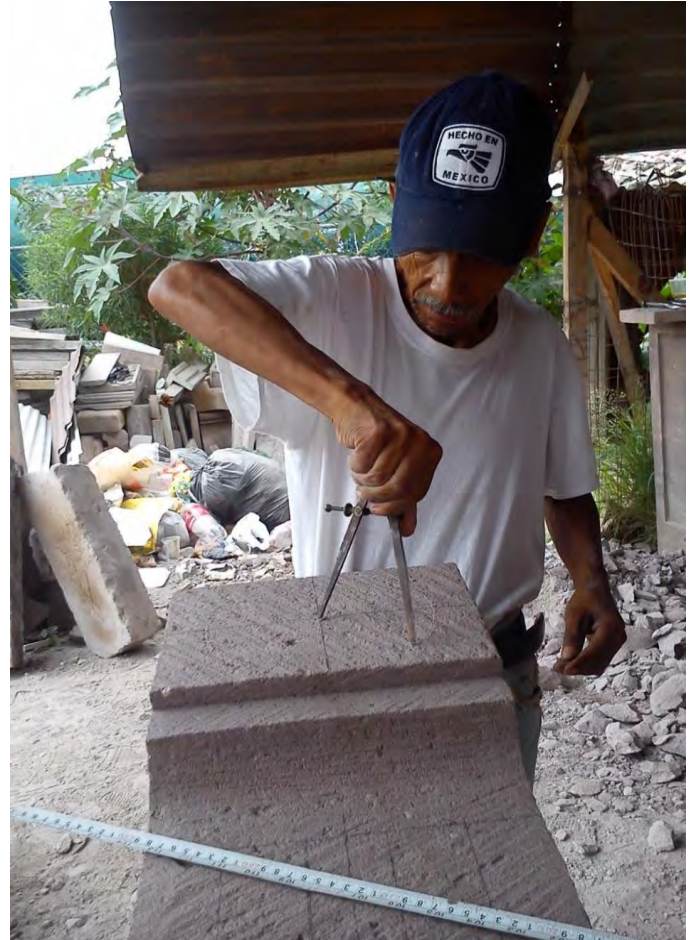
Figura 20. Cantero utilizando un compás de acero Taller de labrado de cantera "Hermanos Vázquez" en San Miguel de Allende, Gto. Foto de Ruth Olvera, 2016.
