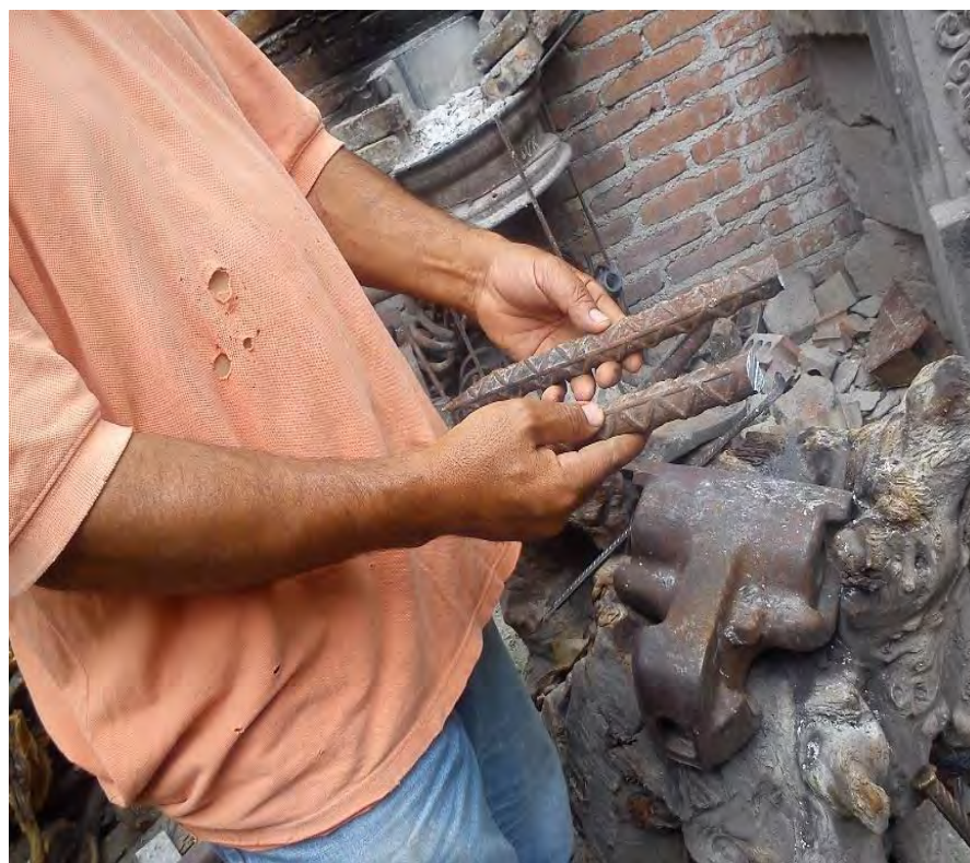
Fig. 18. Se muestra al cantero Javier Olvera comparando con material de acero para elaborar cinceles en su taller. Taller de labrado de cantera "ARAIN", San Miguel de Allende, Gto. Foto de Ruth Olvera. 2016.
