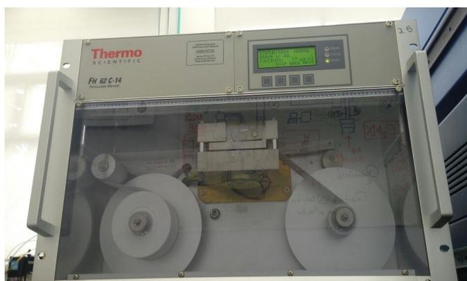
**Figura 6. Monitor de aerosoles alfa/beta. Marca Thermoenviroment. Foto propia.**
