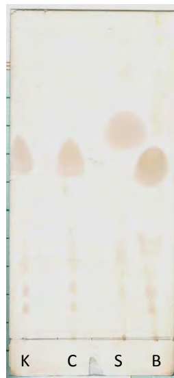
Figura 16. Reacciones de transesterificación con aceite de jatrofa. K representa la reacción con ANCUT1, C la reacción con ANCUT2, S es un estándar preparado por reacción química y B es el blanco de reacción.
