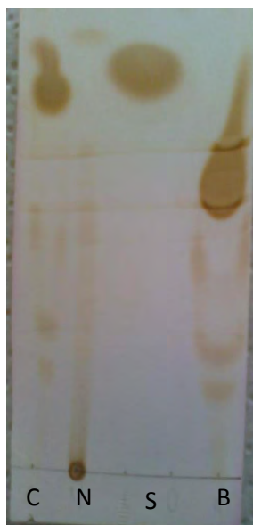
Figura 14. Síntesis de metil ésteres con metanol y aceite de ajonjolí, AN CUT2 y las condiciones indicadas. El carril C indica una reacción con AN CUT2, N muestra una reacción con una esterasa, S es el estándar de metil ésteres y B el blanco de reacción.
