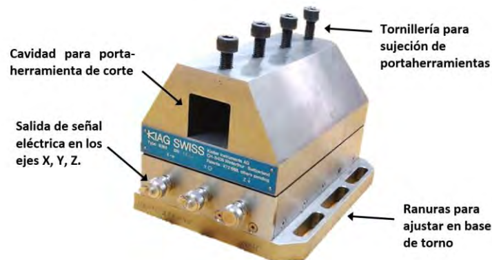
Figura 3.1 Dinamómetro KISTLER Tipo: 9263 SN: 65180, de Facultad de Ingeniería, UNAM.
