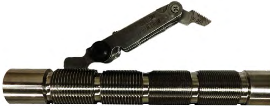
Figura 4.42 Inspección visual con ayuda de patrón para cuerdas externas unificadas.
