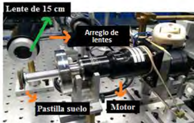
Figura 2.8 Posición de arreglo lentes (izquierda arriba) respecto a la muestra
