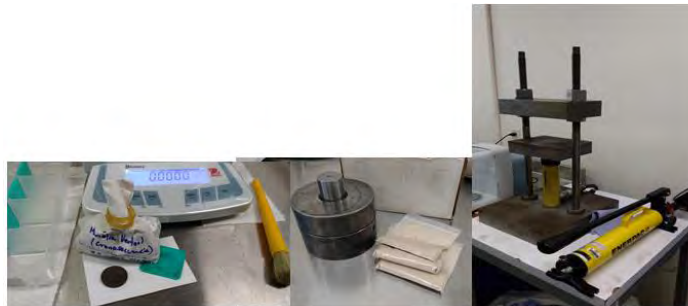
Figura 2.1 Secuencia de pasos para obtener la pastilla, a partir de las muestras de suelo
