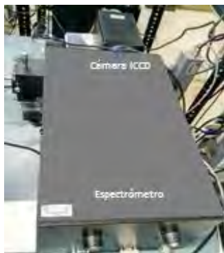
Figura 2.10 Sistema de detección: Cámara ICCD y espectrómetro
