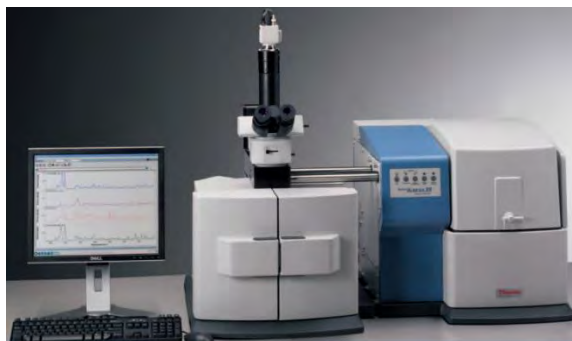
Figura 2.2 Equipo de Espectroscopia de dispersión Raman: compuesto de un microscopio óptico un láser Nd:YAG y un software para controlar el equipo y obtener los espectros
