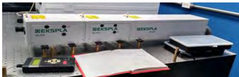
Figura 2.5 Láser Nd:YAG.- Longitud de onda fundamental 1064 nm. Usando el tercer armónico 355nm (longitud de onda en UV)
