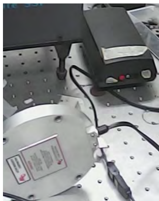
Figura 2.11 Lámpara de Hg (abajo) utilizada para la calibración
