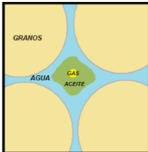
Figura 3. Distribución de los fluidos en los poros.
