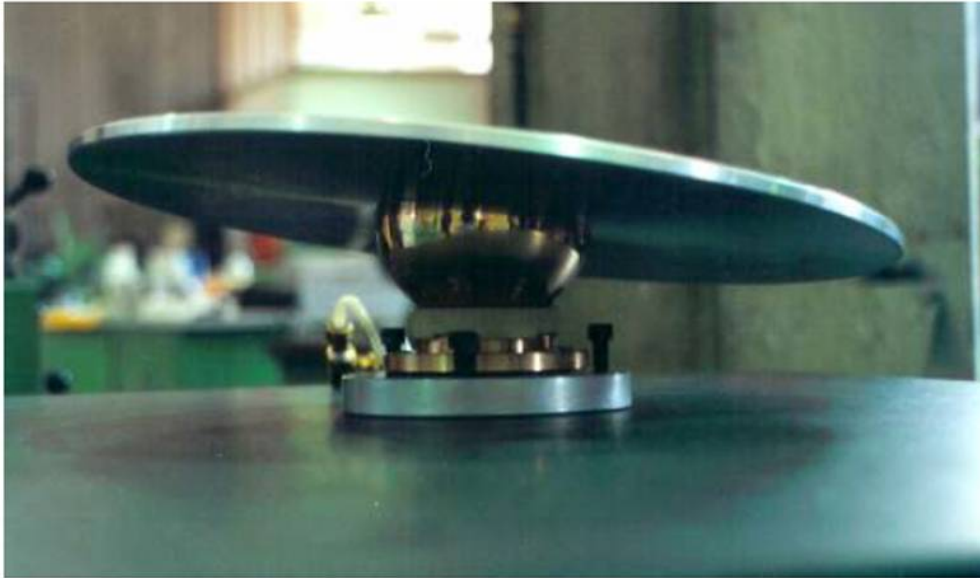
Figura 1.11. Simulador de un medio sin fricción, basado en una plataforma suspendida sobre un cojinete neumático esférico - [1].
