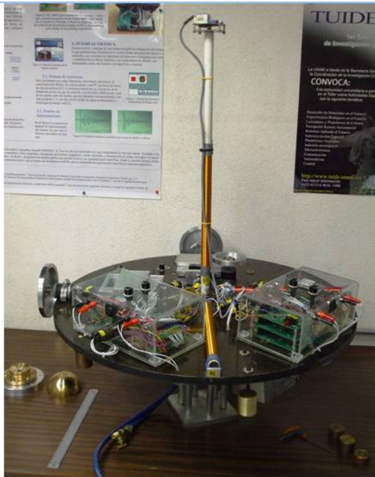
Figura 1.10. Sistema de simulación de un medio sin fricción, SIMUSAT 2.1. En él se encuentran todos los elementos del subsistema de control de orientación: Computadora de a bordo, sensores, actuadores, baterías y sistema de comunicación bidireccional inalámbrico. [1]
