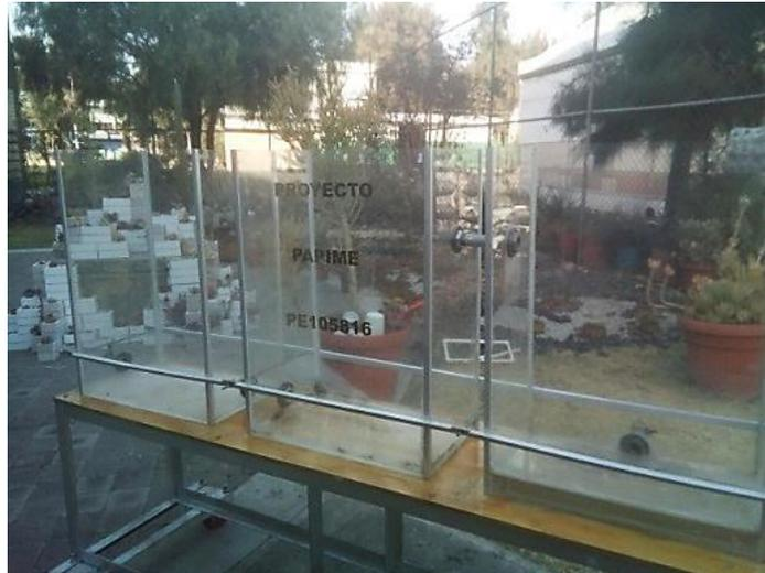
**Figura 8. Elaboración de recipientes de acrílico que servirán para hacer las muestras de permeabilidad.**
