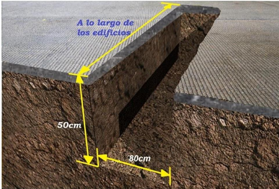
**Figura 16. Excavación de zanja con dimensiones propuestas.**
