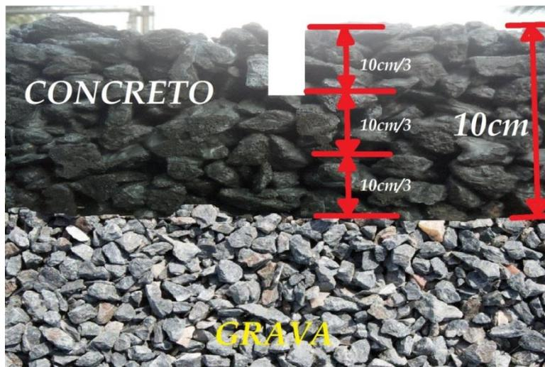
**Figura 25. Trazo de la junta a una tercera parte del espesor del concreto permeable.**
