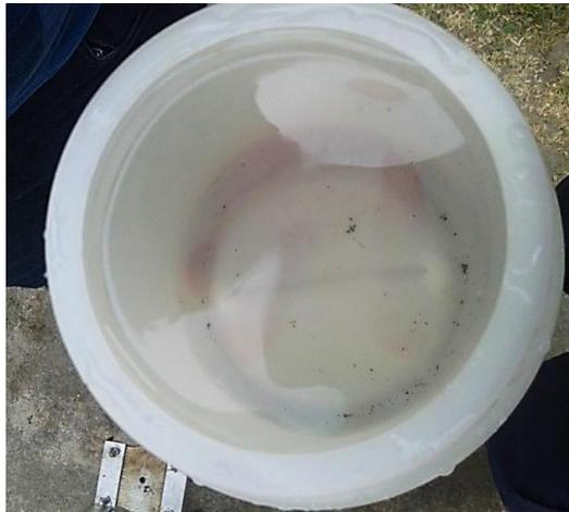
**Figura 13. Recipiente con agua de salida de la muestra "A" (SA), después de realizar la prueba de permeabilidad.**
