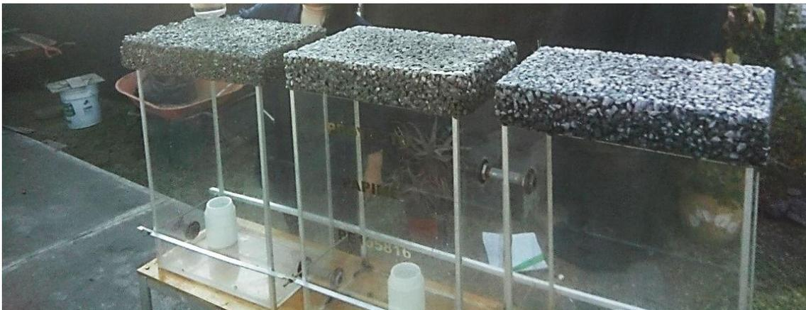
**Figura 11. Colocación de cada muestra en recipientes de acrílico.**
