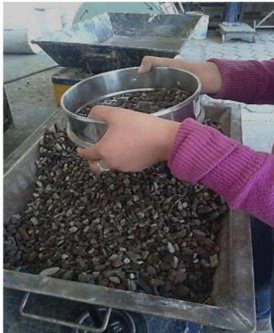
**Figura 3. Tamizado de agregado grueso.**
