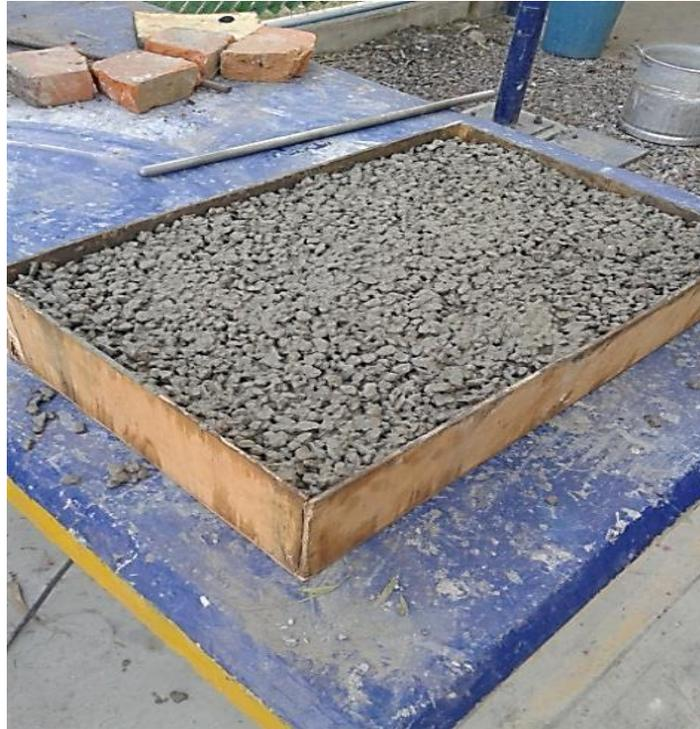
**Figura 6. Colocación de la mezcla en cimbra.**
