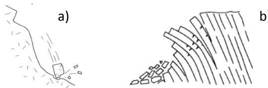
Figura 2. Esquema de caídas y derrumbes. a) Desprendimiento. b) Vuelcos (Corominas y García-Yagüe, 1997).
