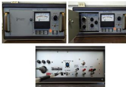
Figura 19. Fuente de alto voltaje (Modelo 152A CORONATROL)
