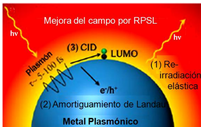
Figura 1.7. Esquema que muestra los tres mecanismos de decaimiento de las oscilaciones superficiales del plasmón. Además existe una mejora del campo eléctrico en la cercanía de la nanopartícula [48].
