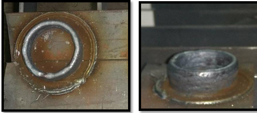
Figura 55. Vista superior y frontal de un cilindro creado en manufactura aditiva para metales.
