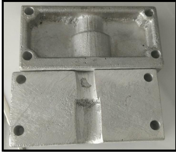
Figura 47. Modelo de sujeción hecho de Aluminio en fundición.
