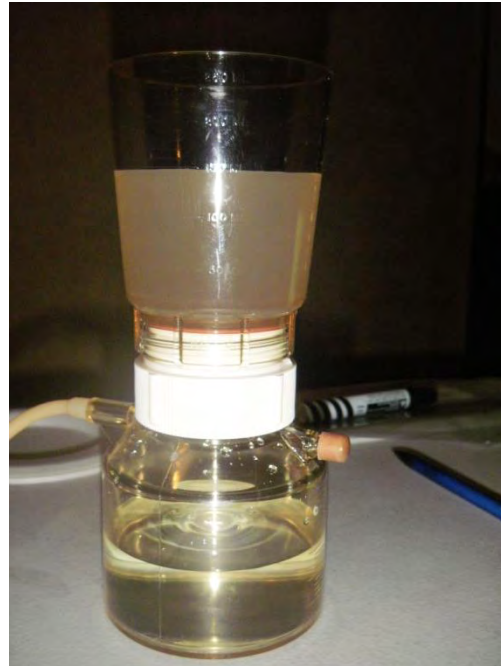
Figura 7.3. Material de filtración a) Filtros para análisis de sólidos mayores de 0.45 \mu\text{m} , b) dispositivo de filtración.
