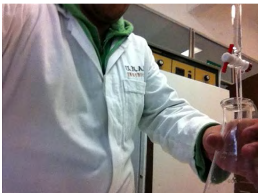
Imagen 4.9. Adición de tiosulfato de sodio por goteo.
