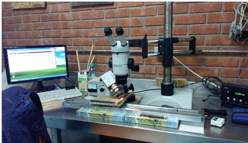
**Figura 3.5. Sistema de medición Velmex conectado a una computadora en donde se puede apreciar el microscopio.**
