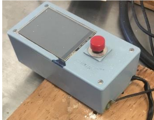
Figura 2.21 Estructura de interfaz con botón de emergencia.
