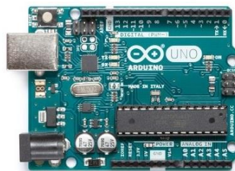
Figura 2.9 Tarjeta ARDUINO UNO con microcontrolador ATmega328P.
