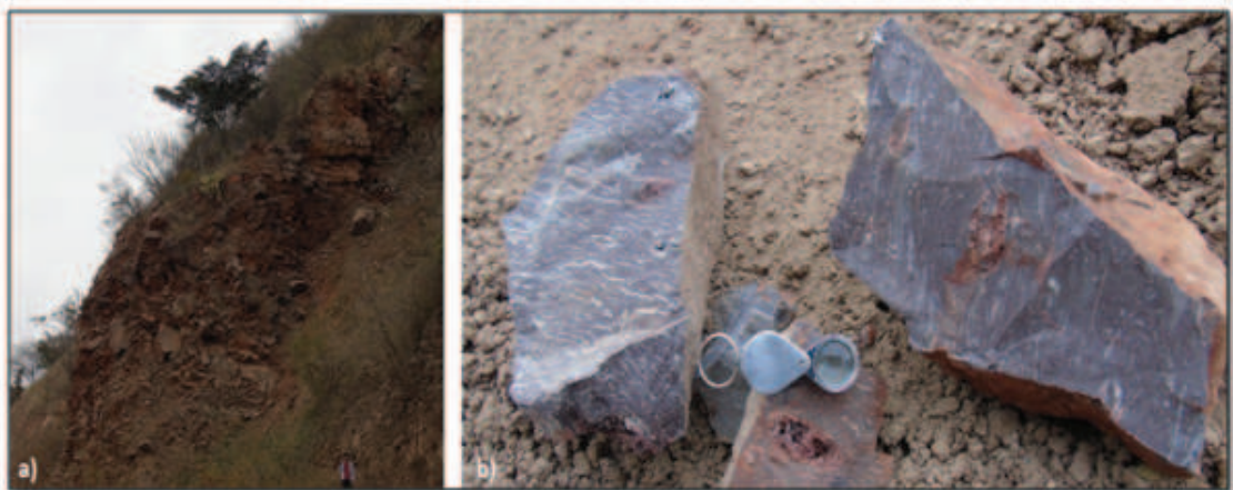
FIGURA 3.3: a) Afloramiento intensamente fracturado Bolaños Inferior. b) Muestras de mano del miembro Bolaños Inferior con textura eutaxítica.
