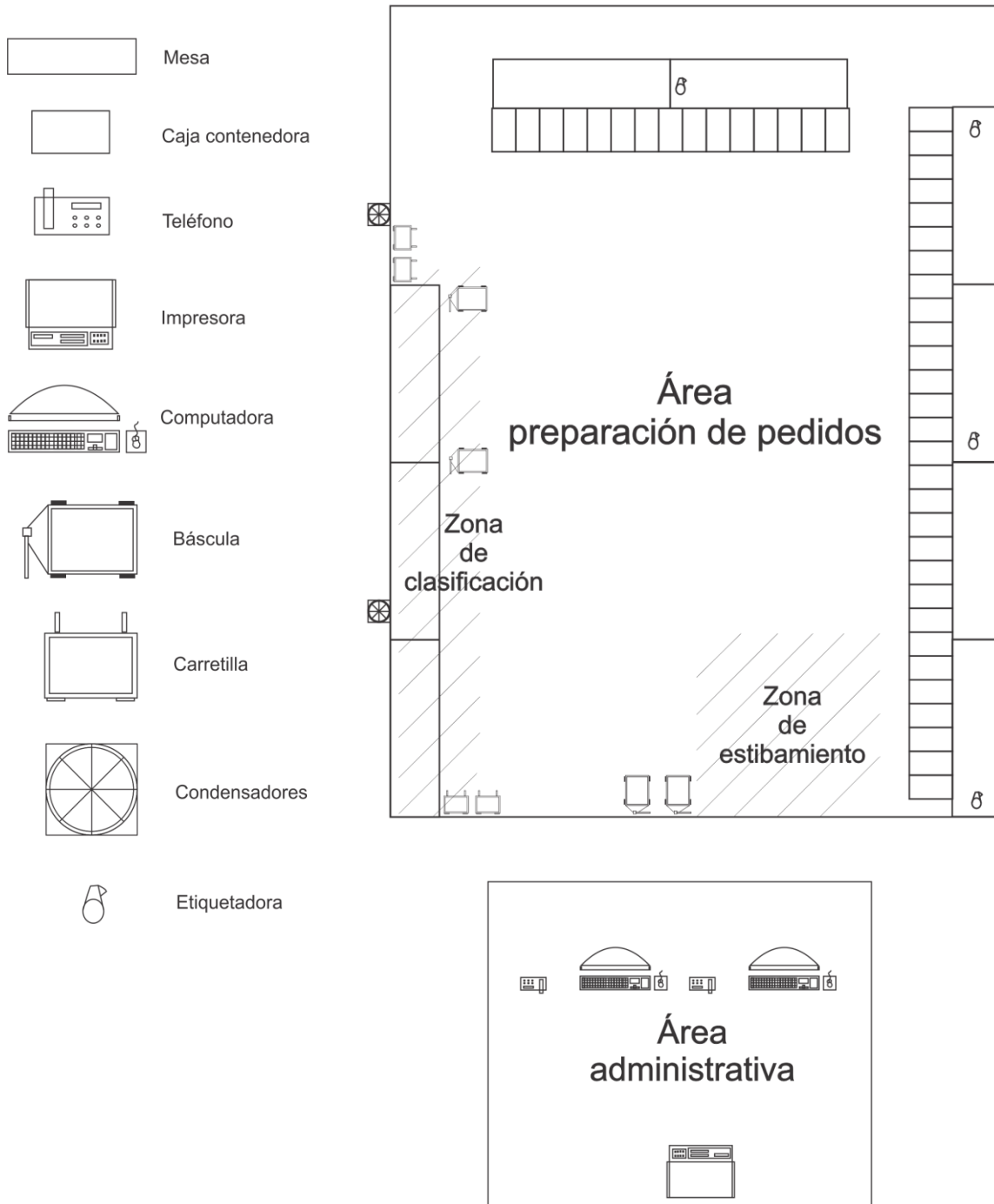
Figura 3.2:1 La distribución del equipo en las áreas de la comercializadora
