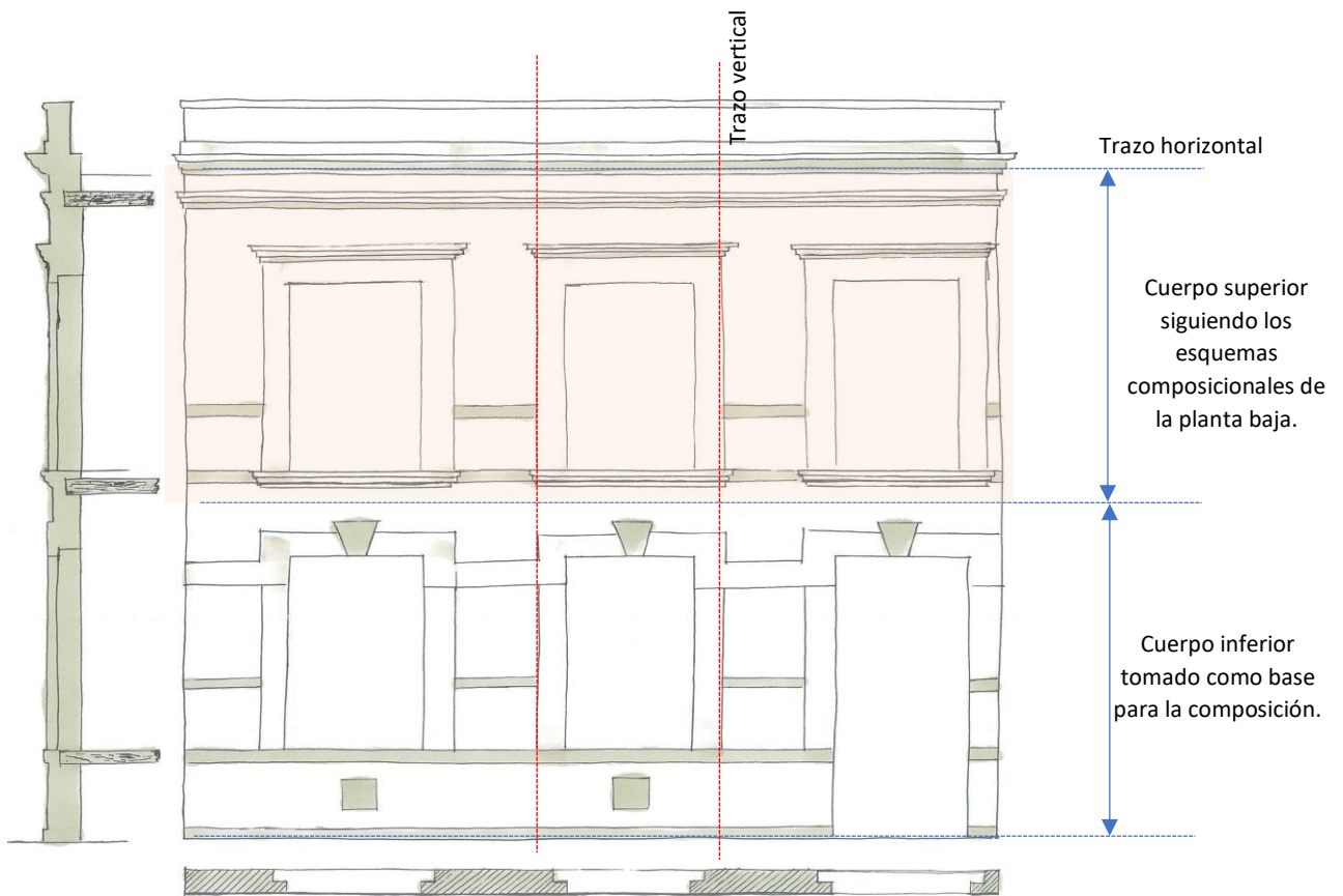
Fig. 48. Construcción de un “nuevo piso”.
