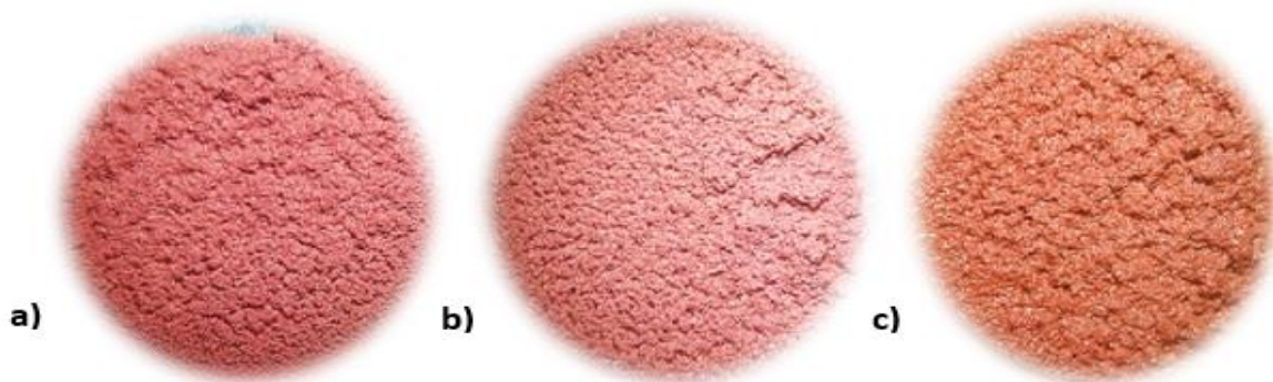
Figura 48 Depósito de cobre como resultado de las curvas de polarización del cátodo. El a) corresponde a la prueba 1, b) corresponde a la prueba 2, c) corresponde a la prueba 3 a las condiciones de 45°C, las pruebas se realizaron con HydroStar® a 25ppm de aditivo.
