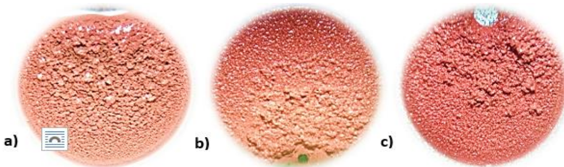
Figura 46 Depósito de cobre como resultado de las curvas de polarización del cátodo. El a) corresponde a la prueba 1, b) corresponde a la prueba 2, c) corresponde a la prueba 3 a las condiciones de 45°C, las pruebas se realizaron con HydroStar® a 10ppm de aditivo.
