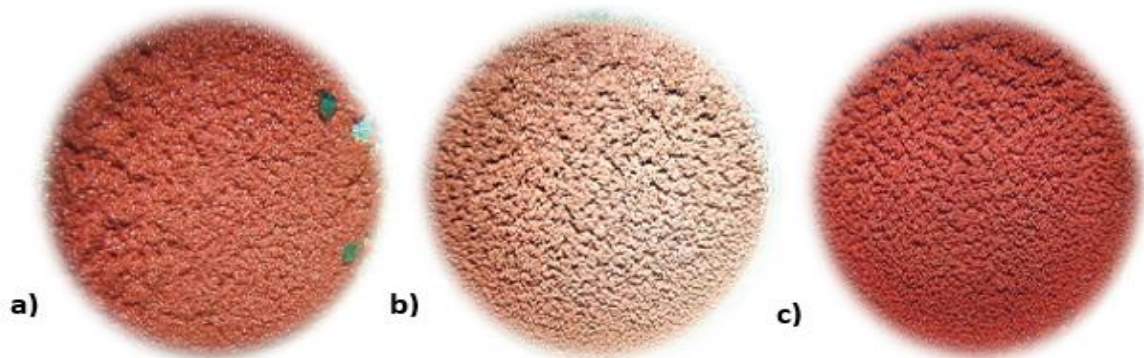
Figura 49 Depósito de cobre como resultado de las curvas de polarización del cátodo. El a) corresponde a la prueba 1, b) corresponde a la prueba 2, c) corresponde a la prueba 3 a las condiciones de 45°C, las pruebas se realizaron con HydroStar® a 30ppm de aditivo.
