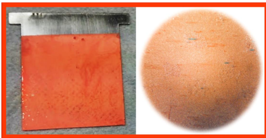
Figura 54 Depósito obtenido a 10 minutos. En la figura de la derecha se observa el depósito visto en el estereoscopio a 45X.
