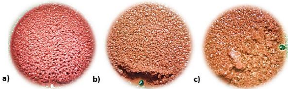
Figura 45 Depósito de cobre como resultado de las curvas de polarización del cátodo. El a) corresponde a la prueba 1, b) corresponde a la prueba 2, c) corresponde a la prueba 3 a las condiciones de 45°C, las pruebas se realizaron con HydroStar® a 5ppm de aditivo.
