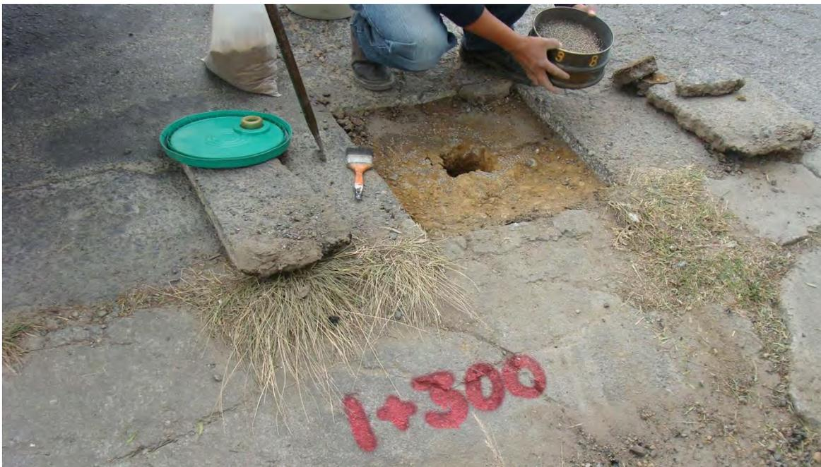
**DETERMINACION DEL GRADO DE COMPACTACION DE LA CAPA DE BASE Y ESPESORES.**
