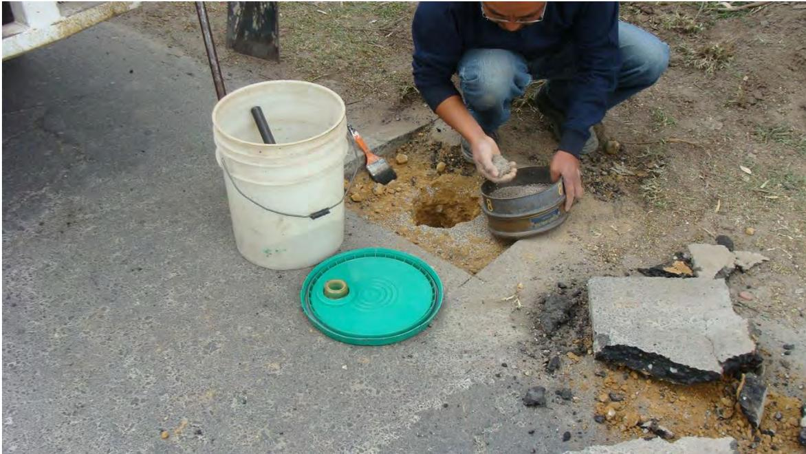
**DETERMINACION DEL GRADO DE COMPACTACION EN CAPA DE BASE Y ESPESORES.**
