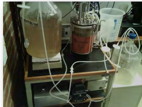
Cultivos en quimiostato a diferentes VTO y a una velocidad específica de crecimiento ( \mu )
