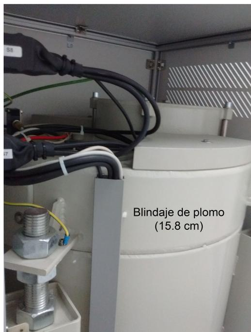
Figura 5.3: Irradiador BIOBEAM GM-2000. Blindaje de plomo (15.8 *cm* de grosor) que recubre al rodillo transportador y la fuente radiactiva.
