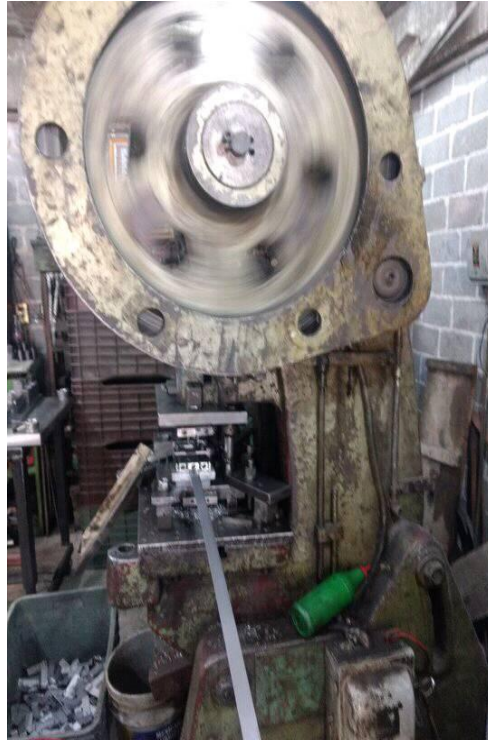
Figura 6. Troqueladora de carrera variable 60 TON (Taller de manufacturas R&R)
