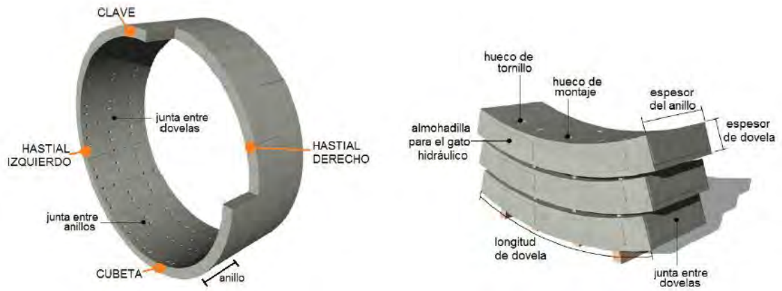
Figura 3.1 Componentes de un anillo dovelado (Groeneweg, 2007).
