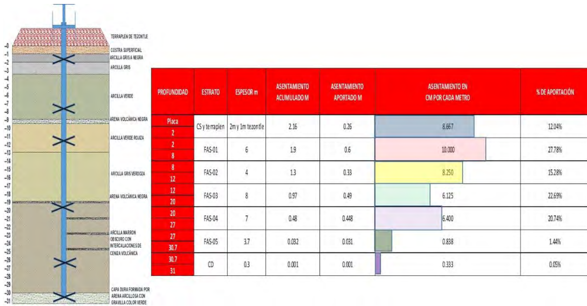
Figura 58.- “Porcentaje de aportación de cada uno de los estratos que se tienen monitoreados con las arañas magnéticas del extensómetro de la bahía Central. Así mismo se muestra la estratigrafía con la ubicación de las arañas magnéticas del extensómetro de la Bahía Central” Fuente: Menard México.
