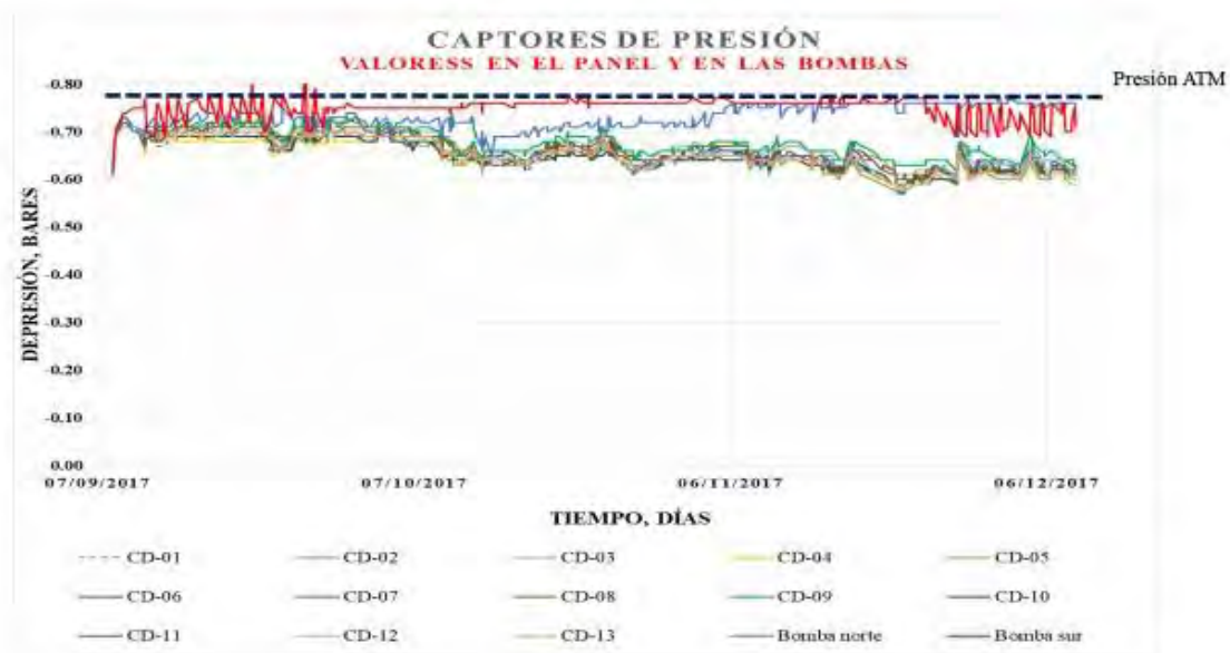
Figura 41.- “Gráfica del comportamiento de las presiones en el panel y las bombas de vacío, con escala vertical mínima y máxima, con el fin de notar la tendencia de las depresiones” Fuente: Menard México.
