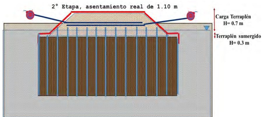
Figura 99.- “Sumersión del terraplén de tezontle durante la segunda etapa constructiva del panel de prueba de vacío (Menard Vacuum)”.
