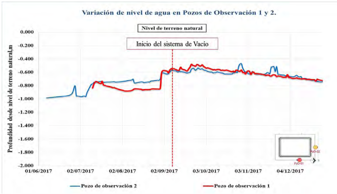
Figura 70.- “Comportamiento del Nivel freático durante la aplicación del Vacío.” Fuente: Menard México.
