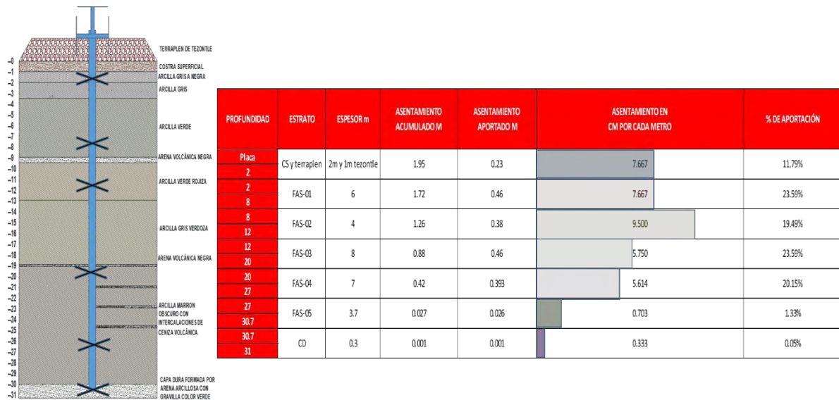
Figura 55.- “Porcentaje de aportación de cada uno de los estratos que se tienen monitoreados con las arañas magnéticas del extensómetro de la bahía Sur. Así mismo se muestra la estratigrafía con la ubicación de las arañas magnéticas del extensómetro de la Bahía Sur” Fuente: Menard México.
