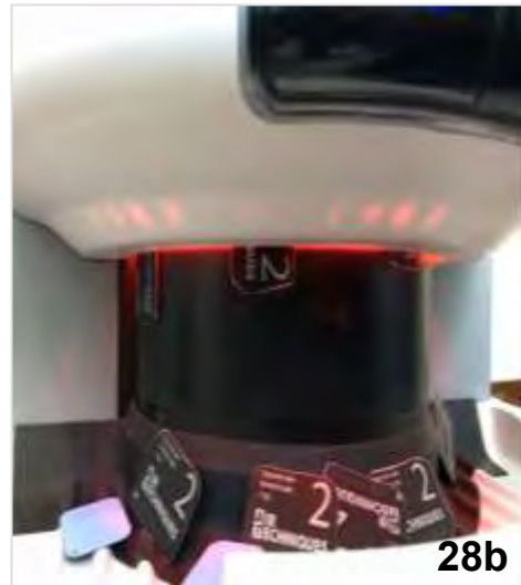
Fig.28a. Introducción de las radiografías de fosforo al Scanx-classic-black. Fuente directa.
