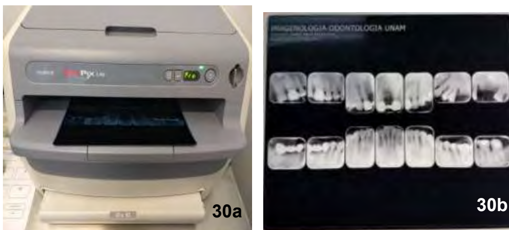
Fig.30a. Impresión de la serie radiográfica digital. Fuente directa.
