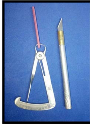
Figura 5. Se aprecia el calibrador a un grosor de 2.5mm
