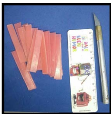
Figura 3. Cera toda estación cortada a las medidas establecidas
