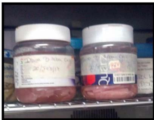
Figura 17. Muestras sumergidas en agua bidestilada dentro de la estufa.
