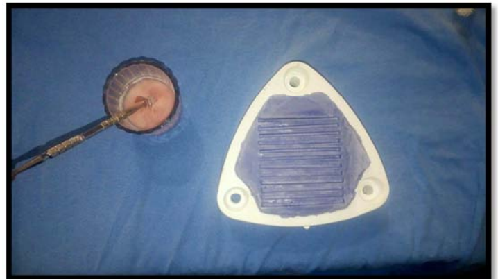
Figura 14. Preparación y colocación del acrílico
