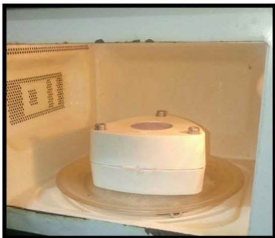
Figura 15. Colocación de la mufla en el horno microondas.
