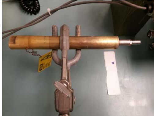
Figura 4.13. Fuente de ^{60}\text{Co} utilizada
