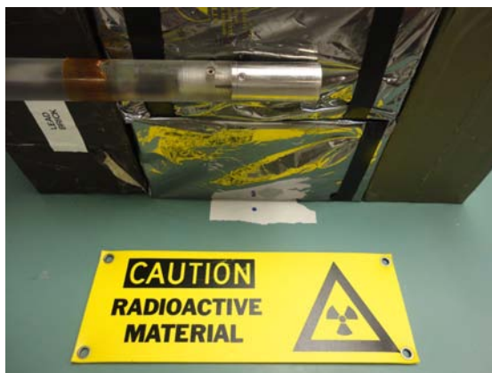
Figura 4.2. Fuente de neutrones de ^{252}\text{Cf} utilizada
