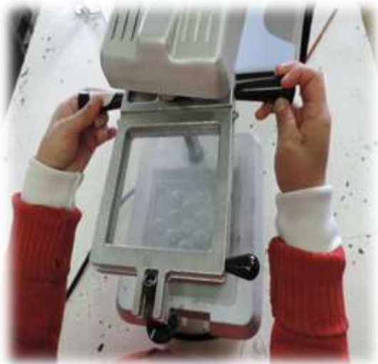
Fig. 14 y 15 Colocación del modelo en termoconformador antes y después de colocar el acetato blando
