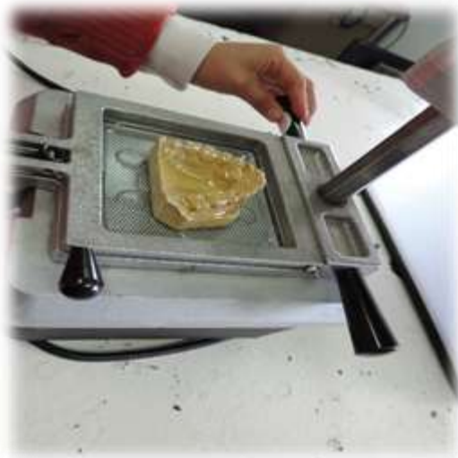
Fig. 14 y 15 Colocación del modelo en termoconformador antes y después de colocar el acetato blando
