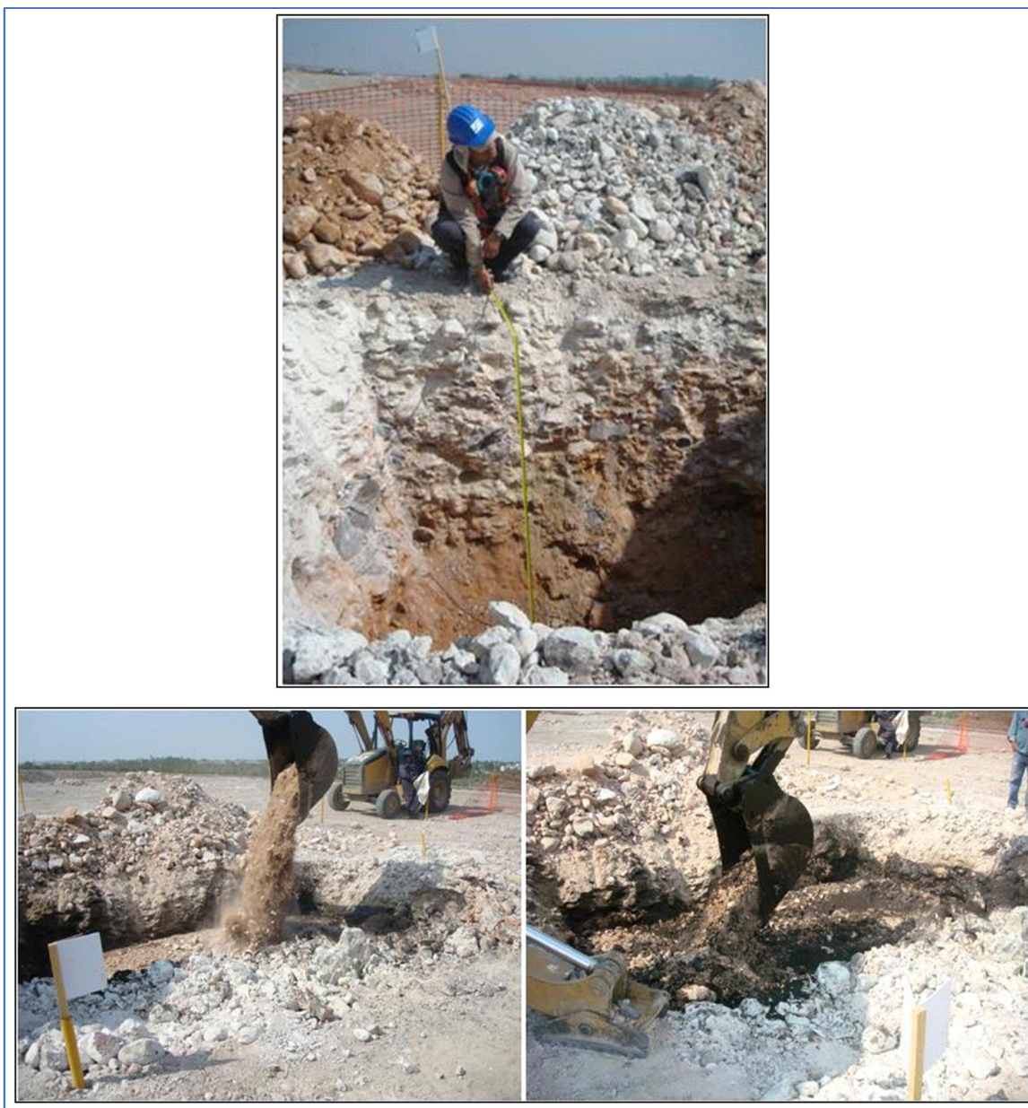
Figura 57. Aplicación de reactivos en zanja de experimentación.
