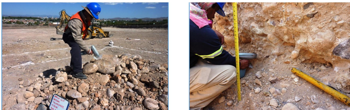
Figura 52. Parcelas de estabilización y análisis de As, Cd y Pb con equipo portátil de Fluorescencia de Rayos X Niton.
