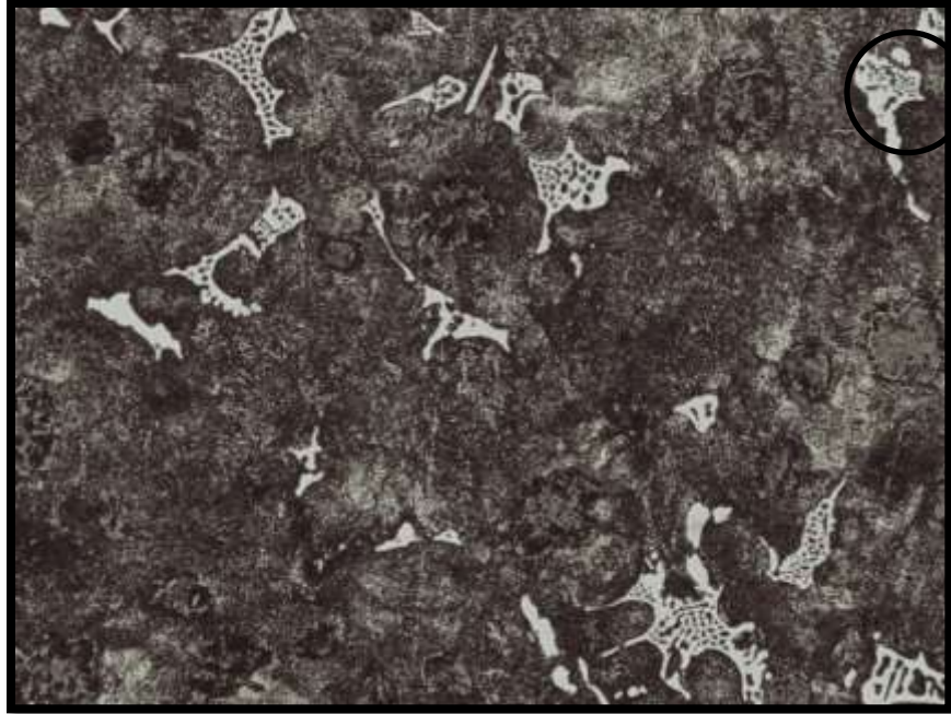
Fig. 34. Muestra representativa de ataque con solución de NaCl al 1% 100x
