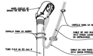
**DETALLE D MUFA PARA LUCES DE OBSTRUCCION SIN ESCALA**
