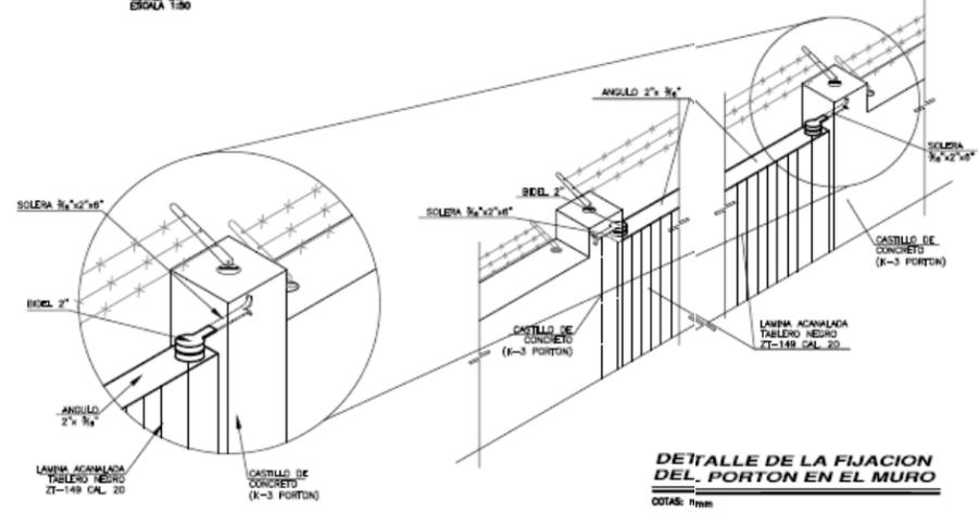
**DETALLE DE LA FIJACION DEL PORTON EN EL MURO**
