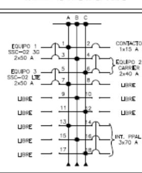
**TABLERO DE DISTRIBUCION NQ18-4L100(S) DE CA-220-220 VOLTS, 3 FASES 4 HILOS 18 CIRCUITOS**
