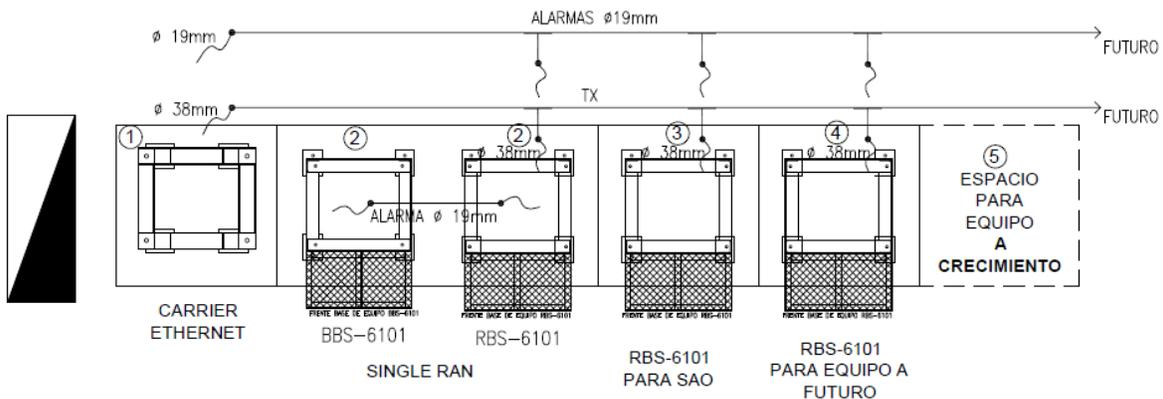
**Imagen 41.-** Detalle conexiones para transmisión y alarmas.
