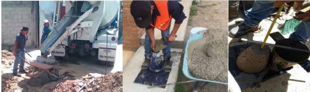
**Imagen 26.-** Concreto para prueba de revenimiento y cilindros.
