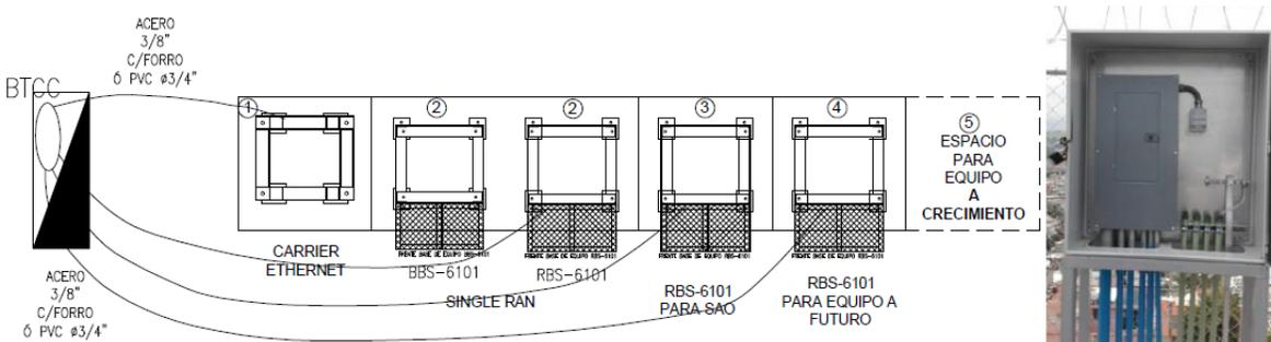
**Imagen 39.-** Conexión de gabinetes al anillo de tierras del centro de cargas.
