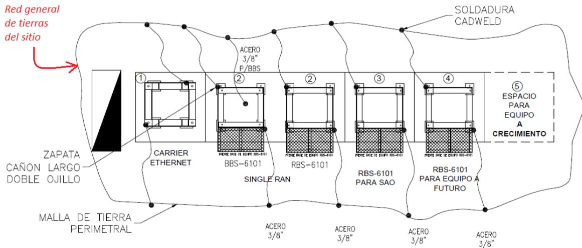
**Imagen 38.-** Conexión de bases metálicas de equipos al sistema general de tierras.
