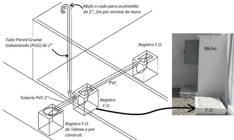
**Imagen 42.-** Detalle canalizaciones para F.O.
