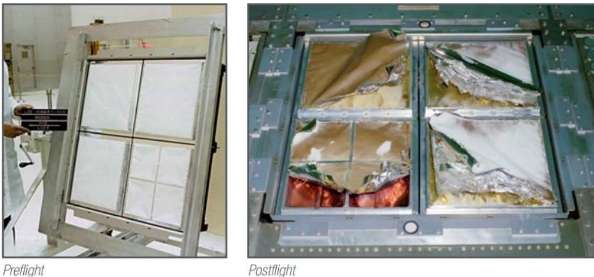
Figura 3. Efectos de la degradación ultravioleta y erosión por oxígeno atómico. [3]
