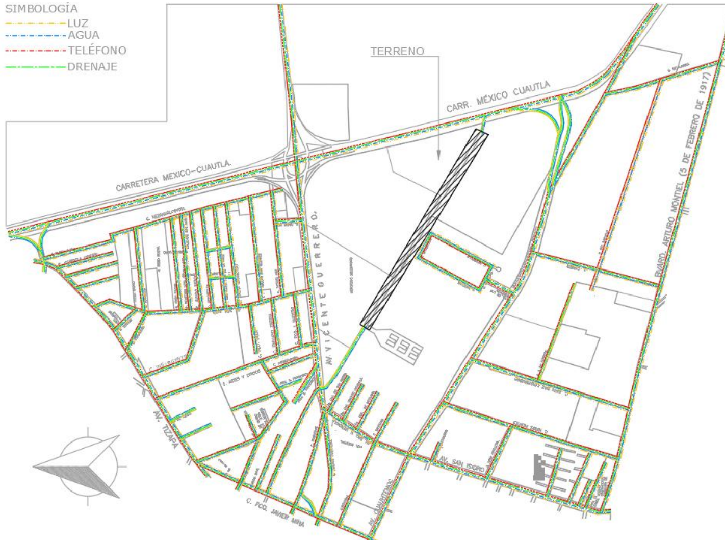
Ilustración 41: Plano de infraestructura.
