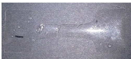
Figura 26. Probeta tipo “hueso de perro” (Dogbone) de una muestra membrana de PVA.
