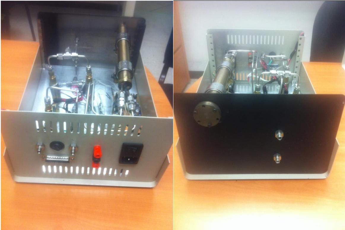
Figura 39. Generador de gases montado en una caja de acero inoxidable.
