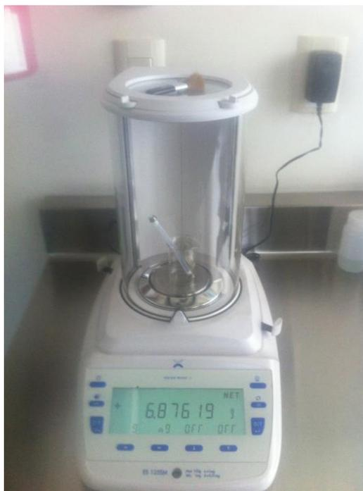
Figura 51. Tubo de permeación siendo pesado en una microbalanza.
