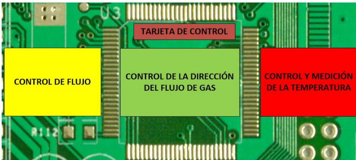
Figura 31. Esquema de la tarjeta de control.
