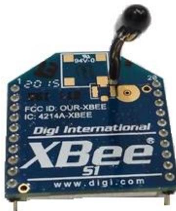
Figura 4. Módulo XBee
