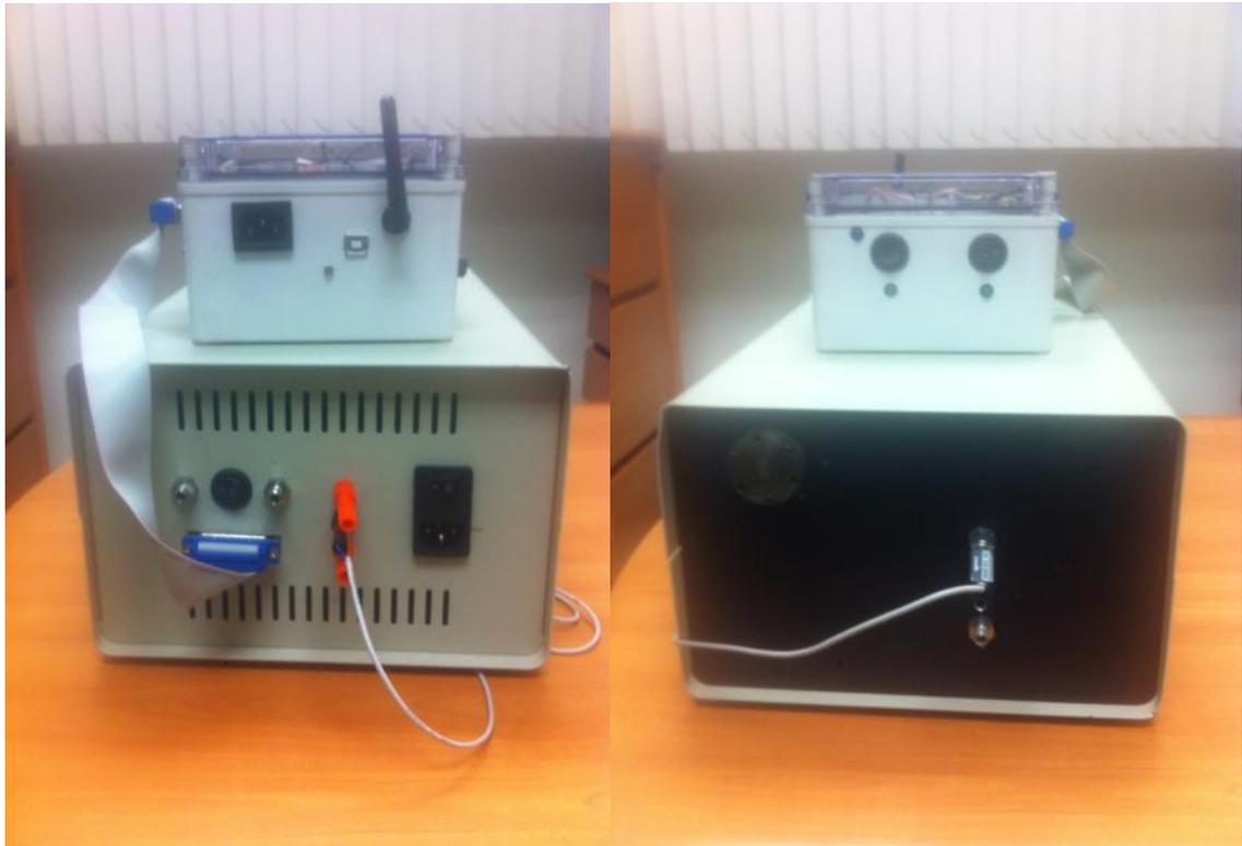
Figura 42. Caja de control y generador de gases.
