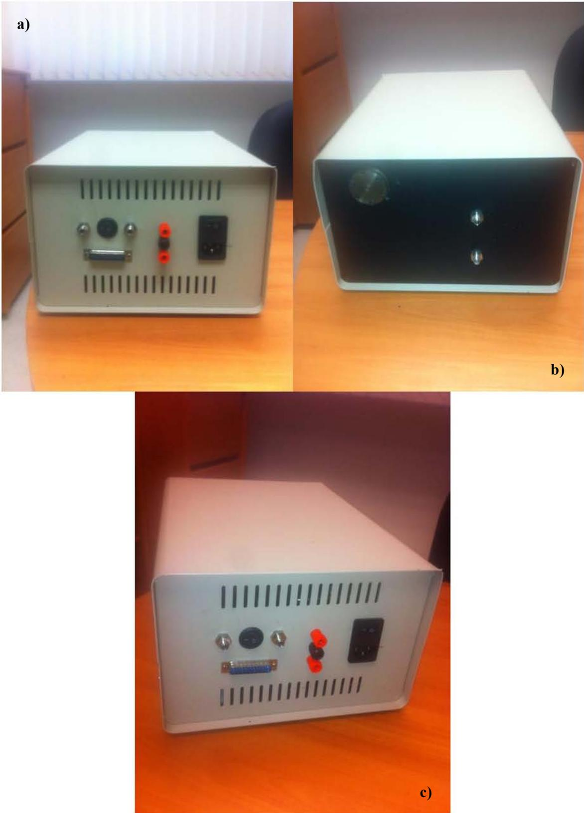
Figura 40. a, b y c) Generador de gases portátil.
