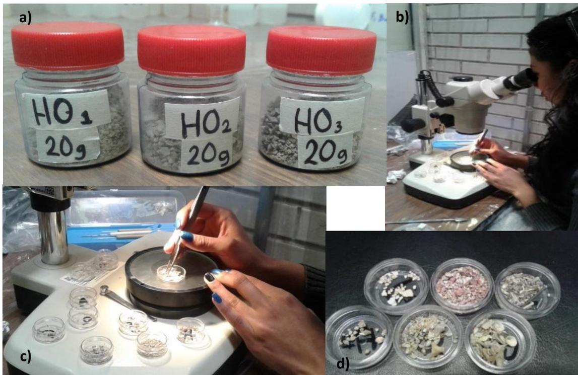
**Figura 11. a) Muestras de 20 g tamizadas para el análisis (HO= Hornos 3 repeticiones); b) y c) separación de fragmentos de sedimento con ayuda del microscopio estereoscópico; d) fragmentos de sedimento separados en grupos**
