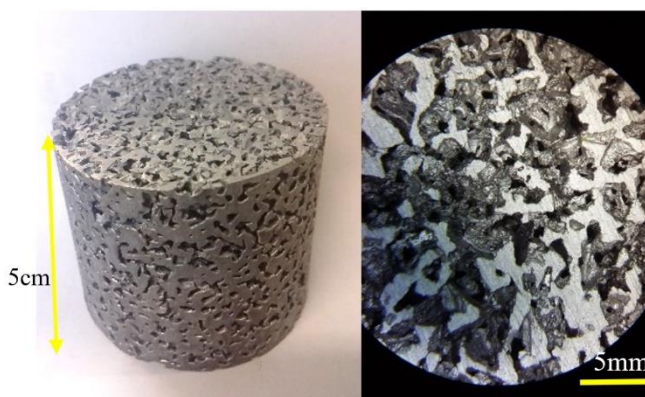
Figura 3.12 Macrografía de la espuma metálica de aleación de aluminio Cu 3 .
