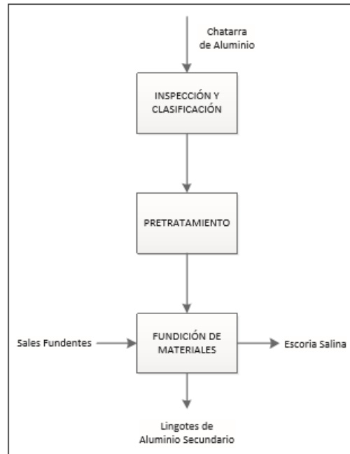
Figura 3. Procedimiento general de producción de aluminio secundario [9]
