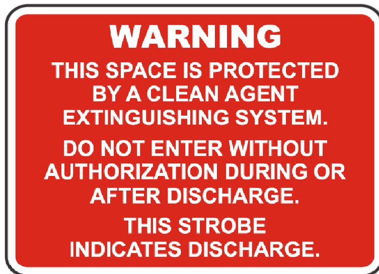
Figura 5.2 Señalamiento que se coloca en la puerta del cuarto protegido
