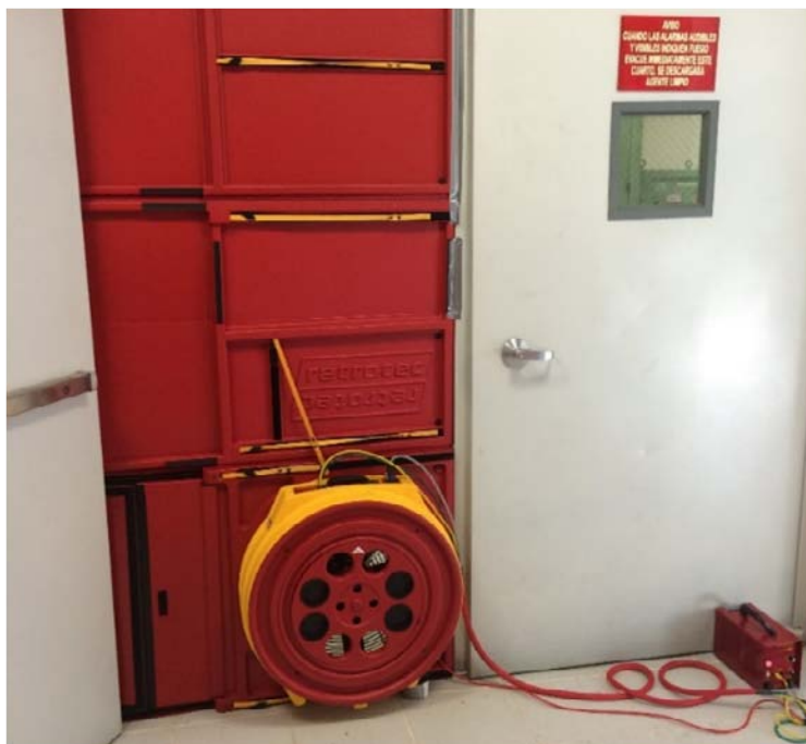
Figura 5.13 Equipo para realizar la prueba Door Fan Test
