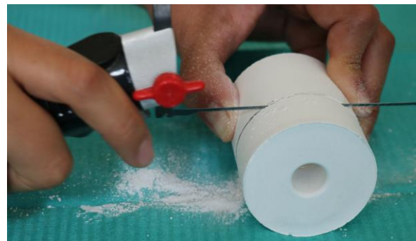
Figura 69. Se cortó el cilindro con una sierra.
