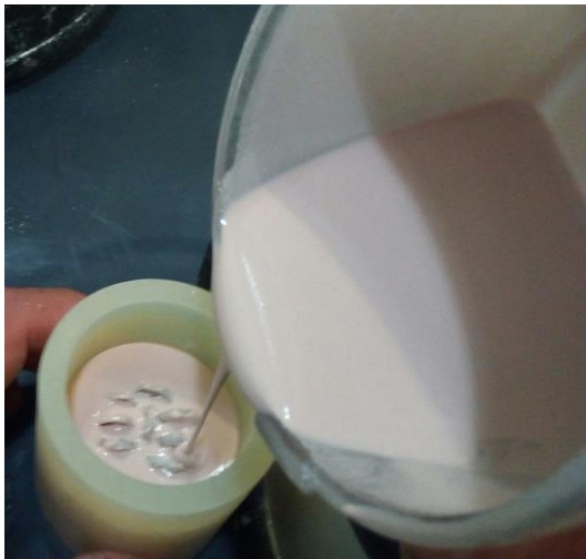
Figura 59. Llenado del cilindro con el revestimiento.
