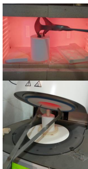
Figura 66. Colocación de las pastillas IPS e.max y pistón.
