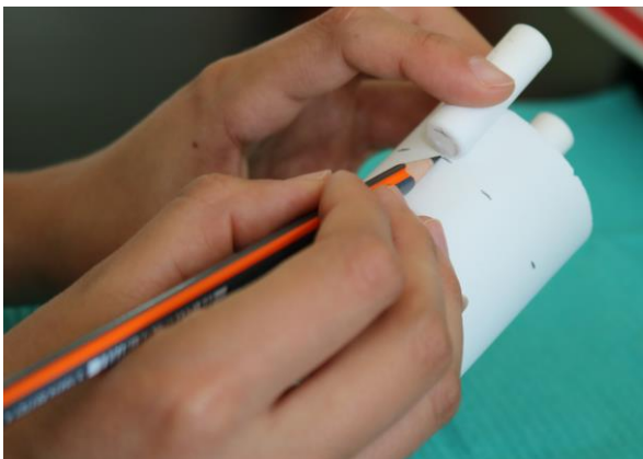
Figura 68. Marcamos la longitud del pistón sobre el cilindro.
