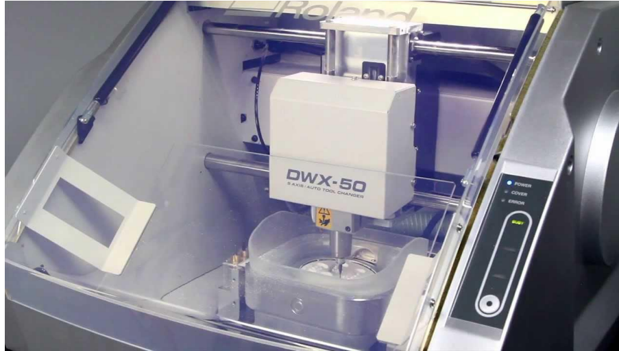
Figura 50. Maquina fresadora DWX-50 (Roland DGA Co ®).
