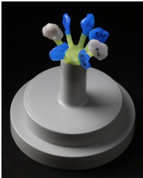
Figura 53. Colocación del encerado en la base del anillo de inyección.
