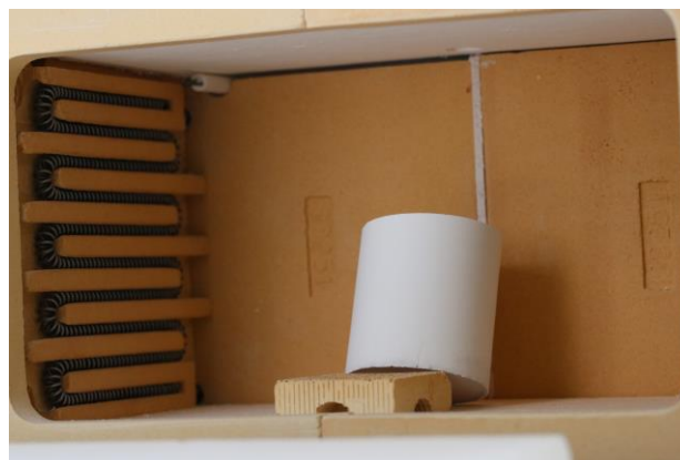
Figura 64. Cilindro de revestimiento en el horno de precalentado.
