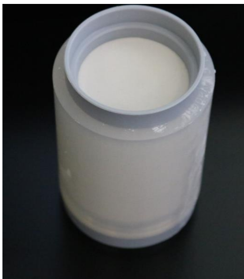
Figura 61. Cilindro con el revestimiento en etapa de fraguado.
