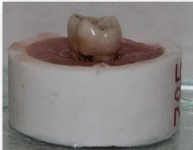
Figura 18. Vista lateral de diente posicionado y fijado en sujetador de PVC mediante PMMA autopolimizable.
