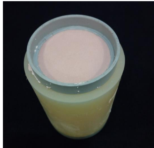
Figura 60. Colocación de la guía sobre el cilindro.
