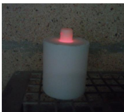
Figura 67. Enfriado del cilindro sobre la rejilla.
