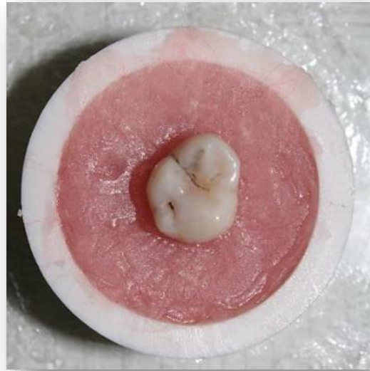
Figura 37. Vista oclusal de diente posicionado y fijado en sujetador de PVC mediante PMMA autopolimizable.
