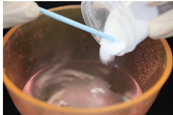
Figura 88. Neutralización con bicarbonato sódico.
