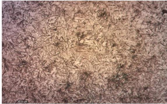
Figura 4.7. Martensita obtenida con una temperatura de austenización de 850°C templada en agua a temperatura ambiente.
