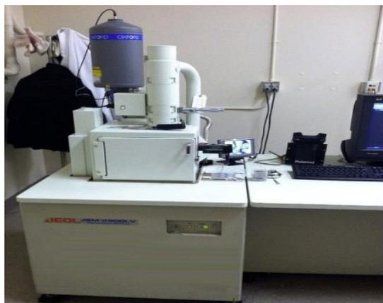
Figura 3.6. Microscopio Electrónico de Barrido.
