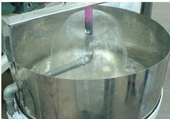
Figura 3.2. Dispositivo utilizado para la realización del ensayo Jominy
