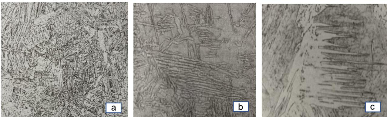
Figura 2.6. a) microestructura de un acero bajo carbono en donde se muestra bainita; b) Bainita en un acero con 0.49% de carbono, c) Bainita formada a una temperatura de  $500^\circ\text{C}$  durante 3 minutos.
