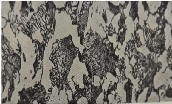
Figura 2.3. Cristales de ferrita y perlita en un acero con 0.35% de C.
