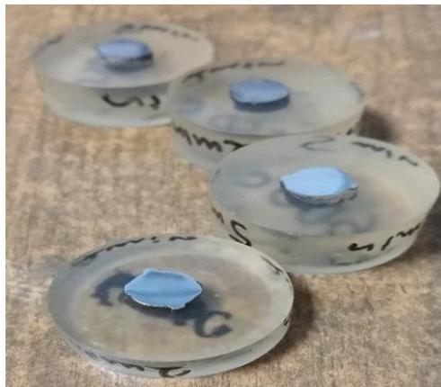
Figura 3.1. Muestras trabajadas montadas en resina.
