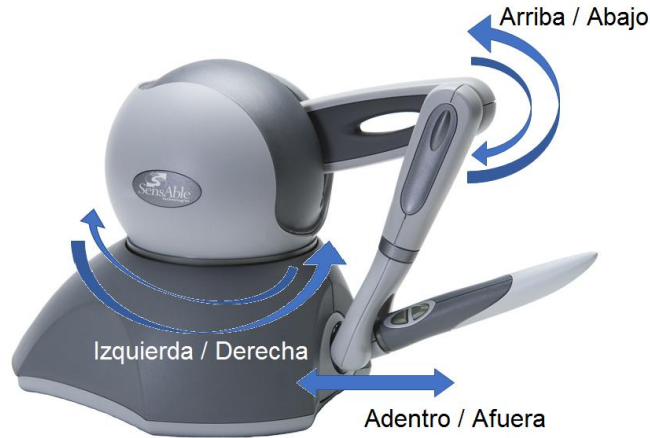
Figura 28. Movimientos del Geomagic Phantom Omni ®. La cabeza principal, de izquierda a derecha, la pluma, movimiento hacia adentro y afuera, el brazo conectado a la pluma, movimiento hacia arriba y abajo. Imagen extraída de (Touch, X, Openhaptics, & Desktop, 2013, p. 22).
