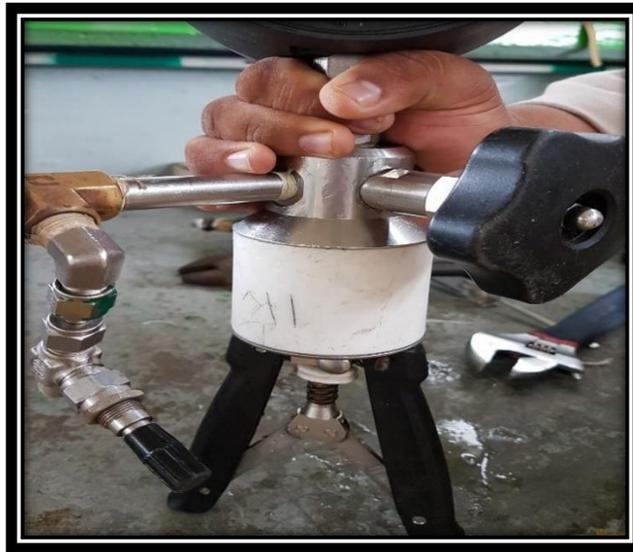
*Imagen 45: Bomba Hidráulica.*
