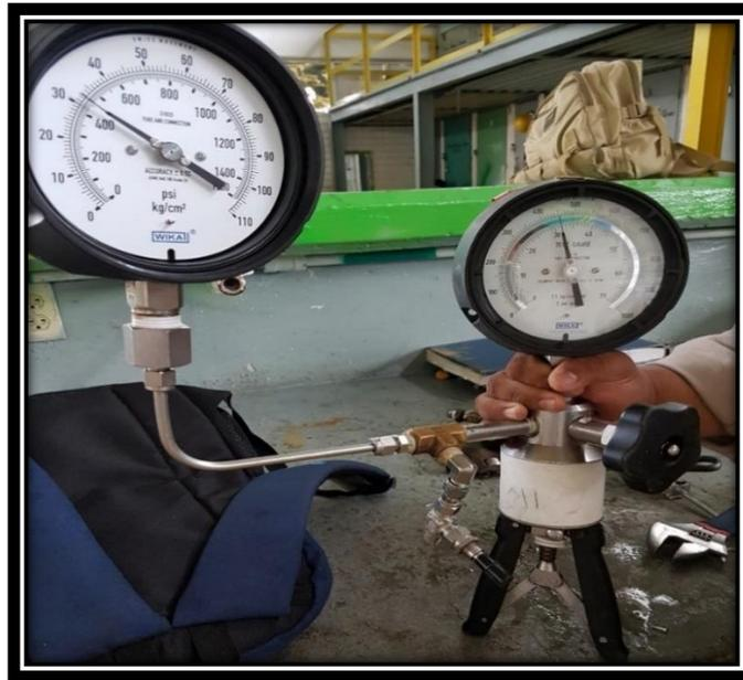
*Imagen 46: Calibración del Manómetro Patrón.*
