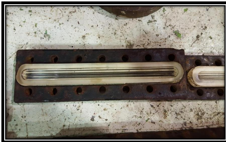
*Imagen 48. Interior de un Medidor de Nivel*
