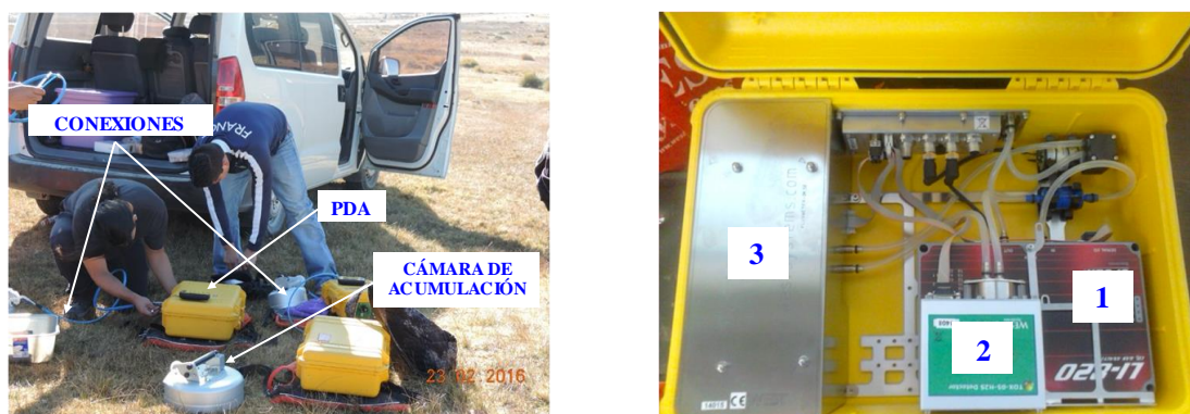
Figura 19. Flujómetro portable WestSystem™. Conexiones de la cámara de acumulación y sensores para medir el flujo de CO 2 , H 2 S y CH 4 . (1) sensor Li-820, (2) celda electroquímica WS-H 2 S-BH y (3) sensor WS-HC-IR.
