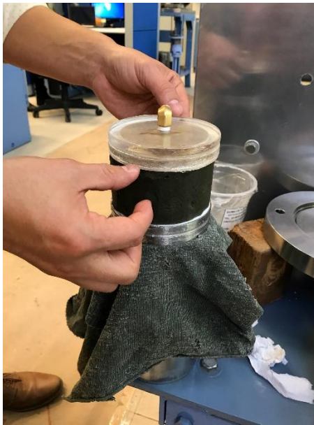
Figura D.3. Montaje en probeta correspondiente a la formación arcillosa superior (29.5 m)
