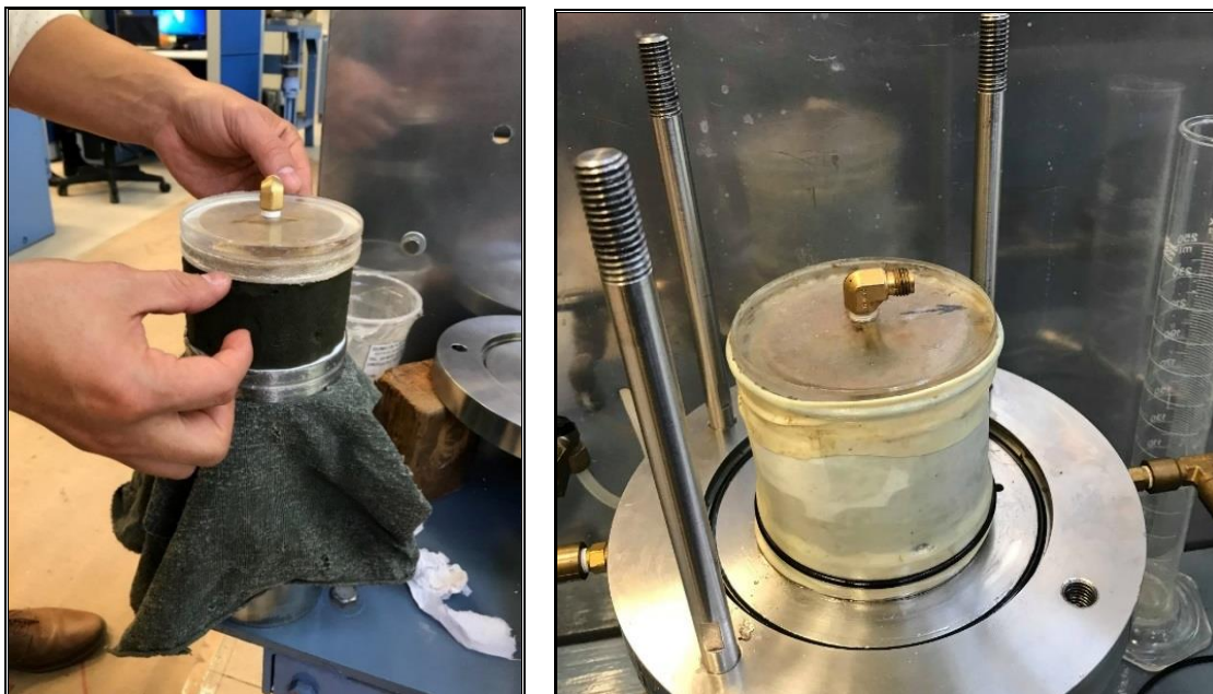
Figura 3.5. Colocación del cabezal superior, membrana y arosellos
