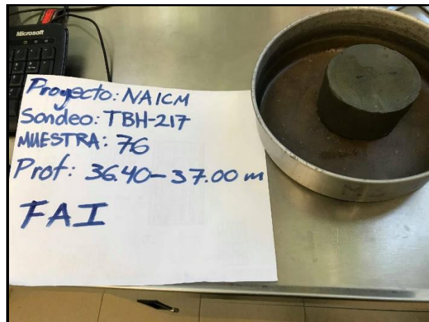
Figura D.4. Probeta correspondiente a la formación arcillosa inferior
