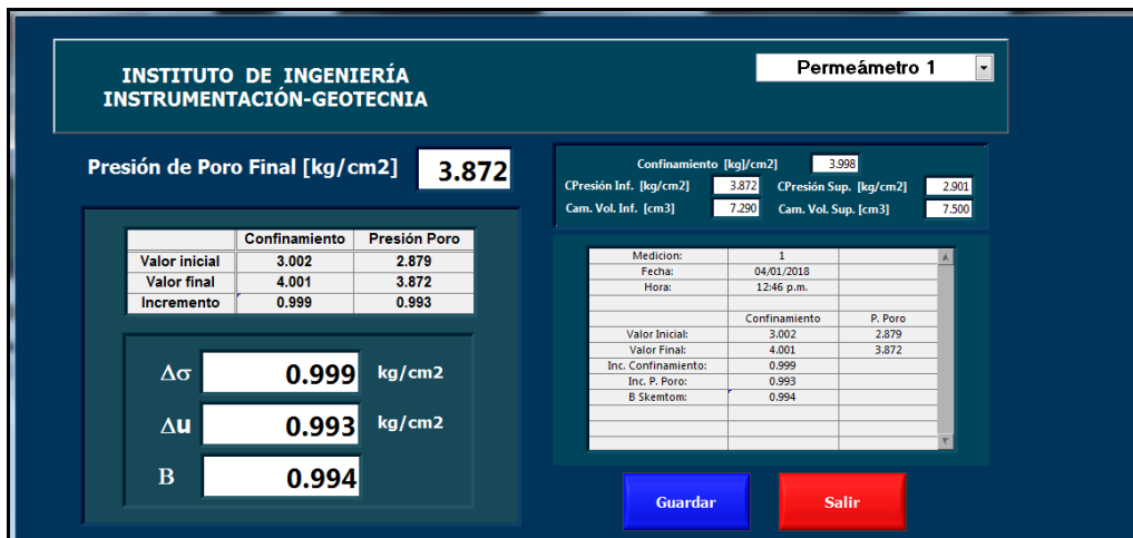
Figura 3.7. Medición del parámetro B de Skempton
