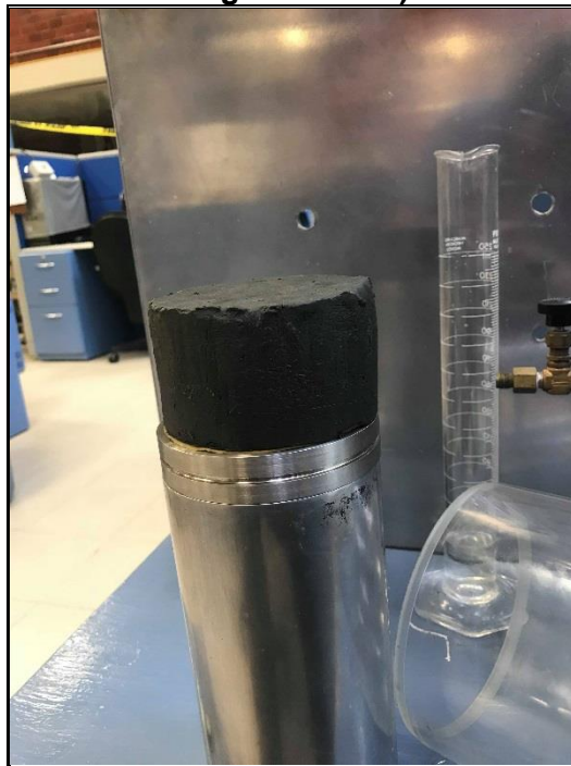
Figura 3.4. Muestra de suelo extraída colocada en el cabezal inferior y resanada con suelo remoldeado
